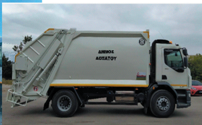
Επίσης, Καινούριο απορριμματοφόρο με σύστημα πλύσης κάδων, 12μ3 μάρκας Mercedes- Benz AROCS 1832K- 4x2 (Δωρεά ΤΑΡ, την οποία δωρεά διεκδικήσαμε)
